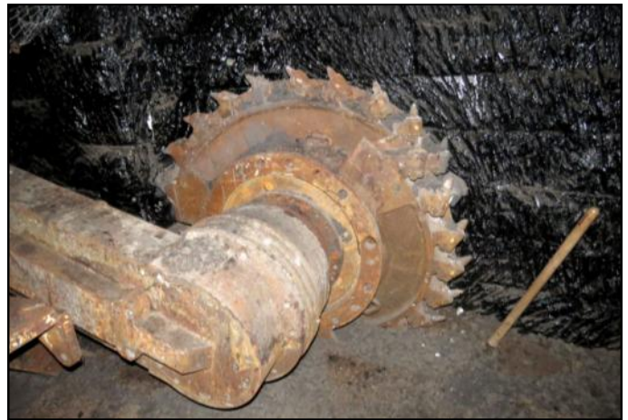
La galerie solidement étayée où nous pouvons voir les différents postes de travail. En bas, la haveuse qui à partir des années 1960 a remplacé le pic des mineurs. (Cl. B. Lips)
