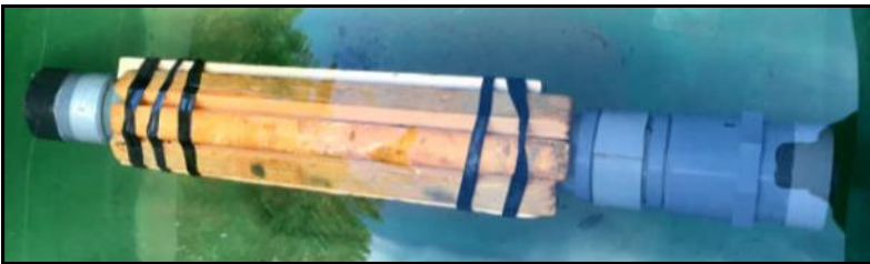
Le délicat emballage de la balise. Les lattes de bois ont été mises pour que l'ensemble ait un poids neutre (même densité que l'eau) et l'impressionnant barda que le plongeur devra emporter dans un environnement peu facile, avec un passage étroit.
