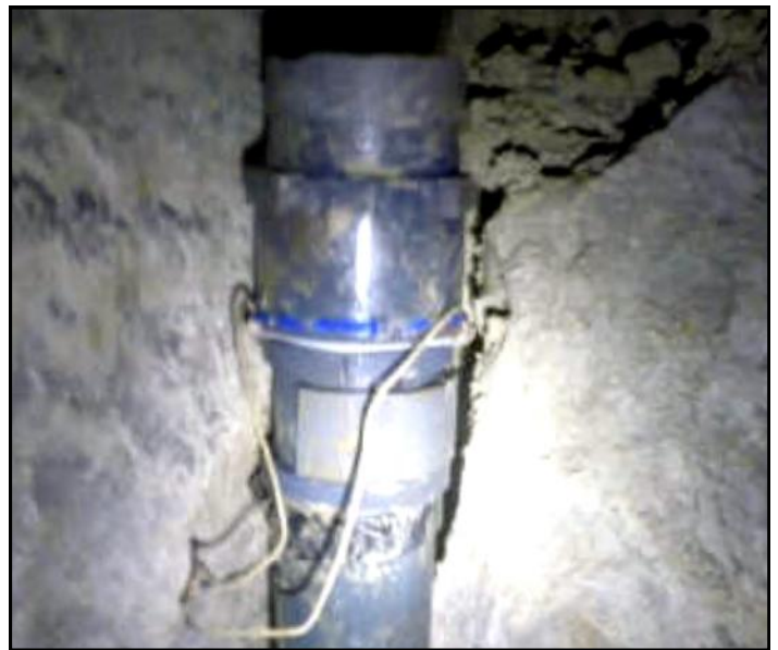
En bas, la balise calée verticalement entre deux rochers de la trémie.
